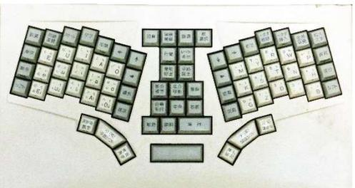
インツクキ縮記法と、キーボードの配置がソクタイブの影響を受けた日本語ワープロであった。打ち方は、特殊なローマ字入力方式の一種で、ドボラク理論の左右交互打の原則にかなう合理的な設計であった。特許出願番号は、一九八一年のS561149631、S561149632、S581203545が確認されている。中根式速記の中根康雄は一九九〇年代に、高速入力可能な「楽キー」を開発、試作した。竜岡博のキーボード集「高天原」には六十七種類のキーボード案が収録されており、日本語の入力に適した入力方式、キーボード配列の研究がブームを呈した。
