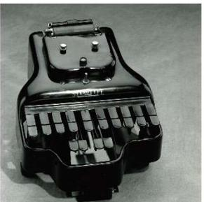
消耗品などを販売していたステノグラフ社は一九三九年、バースロミューの「ステノグラフ」のブランドをつけた最初の機種「セクレタリアル・モデル」を発売した。この機種にインクリボンテープがエンドレスで回る仕組みが組み込まれ、速記用紙の収容量も大きく設計されて、紙送りが静音化された。また外殻シェルにマグネシウム合金が採用されるなど、丈夫で軽くする改善が取り入れられていた。今日でもパソコンの外殻にマグネシウム合金を採用している機種は高級機に限定されるが、このような一連の材料開発は創業者の息子、ロバート・ライトがノースフィールドのカールトンカレッジで物理学の学位をとり、最新材料の分野に理解的であったことによるものである。ロバートはアイアランドの機械の課題を分析して新たに六件の特許を取得し、一九三三年にアイアランドの特許の期限が切れて技術が使えるようになると、名実ともにアメリカの機械速記のリーディング・カンパニーとしての地位を固めていくことになる。
